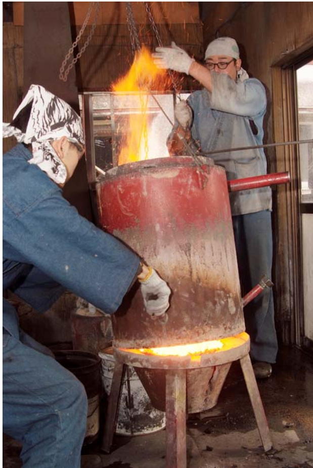
踏鞴炉の解体
